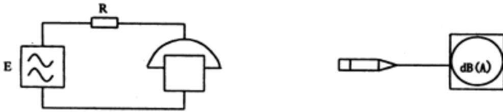
信号源  $E=(75\pm 2)V(\text{rms})$ ; 频率为 25Hz;  $R=(1700\pm 17)\Omega$
